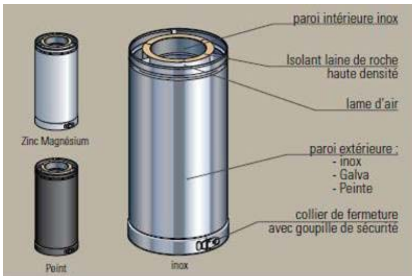
Figure 3 – Description technique d'un élément de conduit
